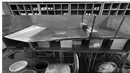
・比較する堤防の形状(発泡スチロール製)
